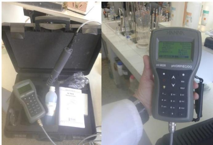
Figura 19. Equipo Multiparamétrico de campo, marca HANNA modelo HI9828
